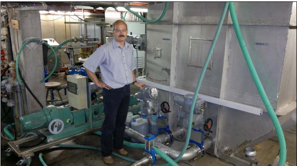
**Abbildung 13:** Technikumsanlage zur Elimination schwerabbaubarer Organik aus Abwasser. Seitenansicht mit zwei Elektroschiebern zur Steuerung des hydrostatischen Ausgleichs. Zum Zeitpunkt des Fotos waren die Druckaufnehmer noch nicht auf die Stutzen (unten rechts) aufgeschraubt.
