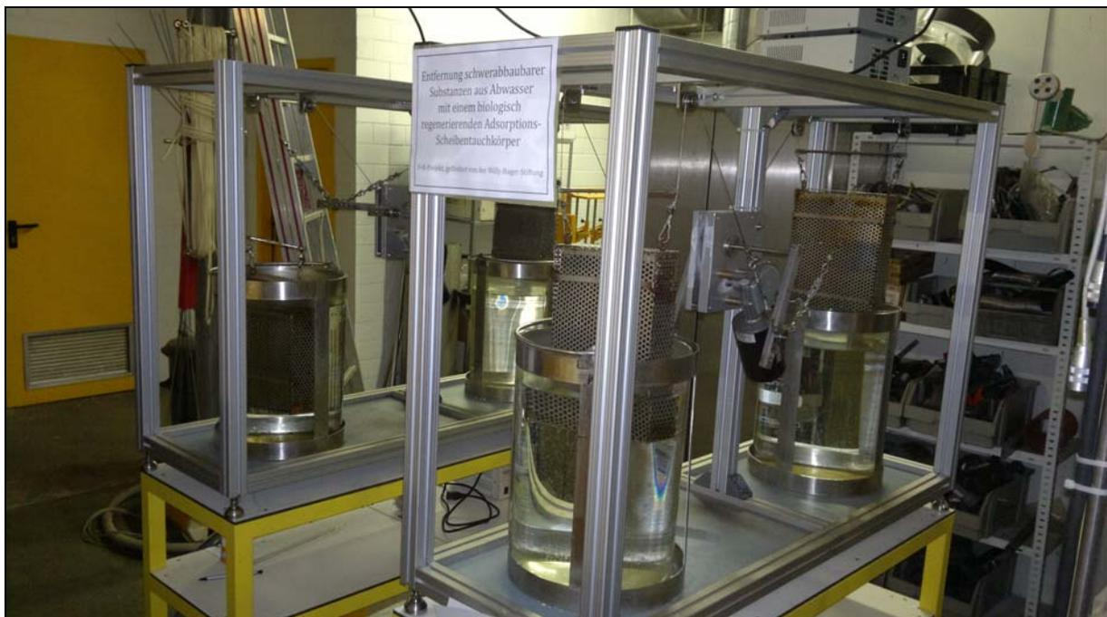
Abbildung 1: Zwei Doppel-Tauchkörperanlagen im Labormaßstab
