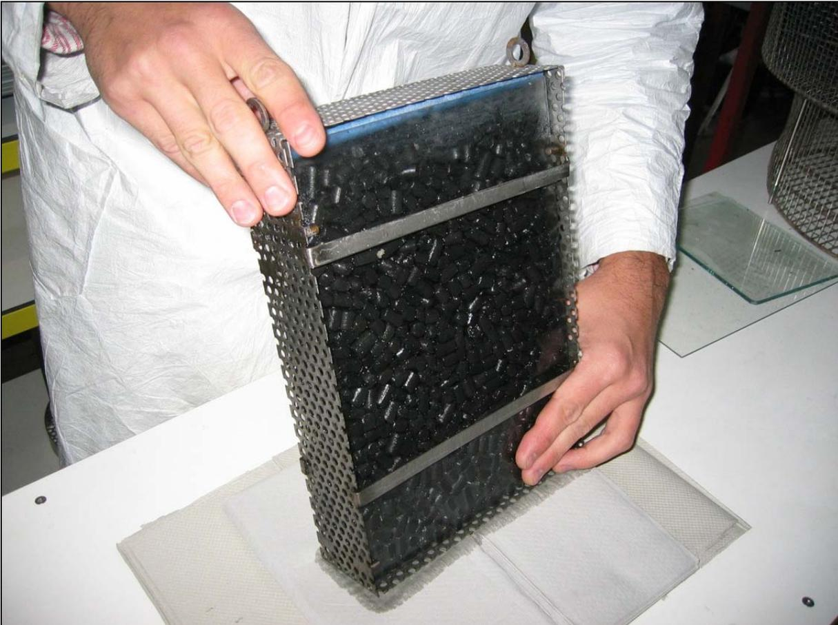
**Abbildung 2:** Tauchkörper gefüllt mit Aktivkohlepellets des Typs K55.
